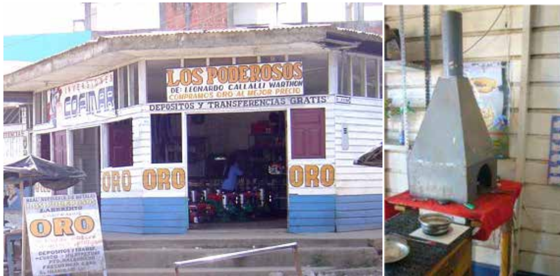
Figura 25. Tienda de oro y un horno de quemado de amalgama en Laberinto, Perú (Fernández 2008).
