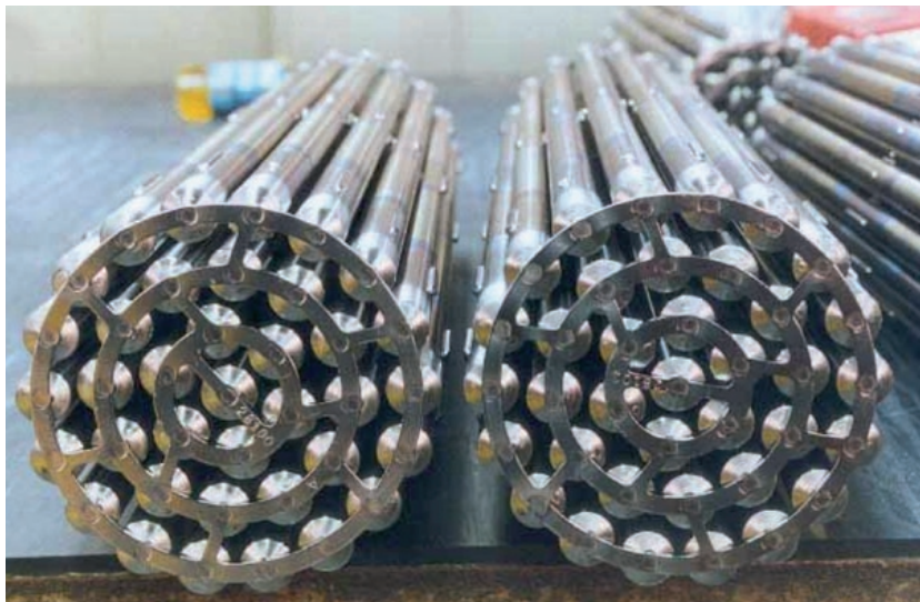
Figura 8. La fabricación del combustible, bajo responsabilidad de la CNEA, se extendió hasta fines de 1987, reemplazando a los combustibles canadienses en la CNE.
