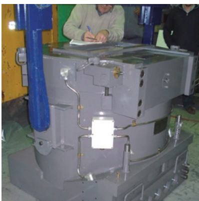
Figura 13. Contenedores para materiales irradiados.
