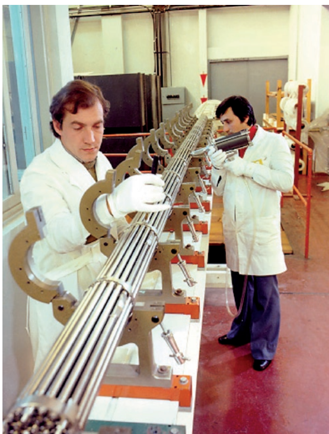
Figura 6. Fabricación de elementos combustibles tipo PHWR para la Central Nuclear Atucha I en CONUAR S.A.
