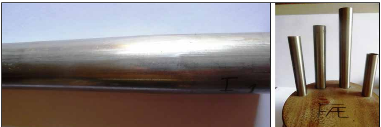
Foto 5: Garganta de un paso intermedio de laminación y tubos finales de zircaloy
