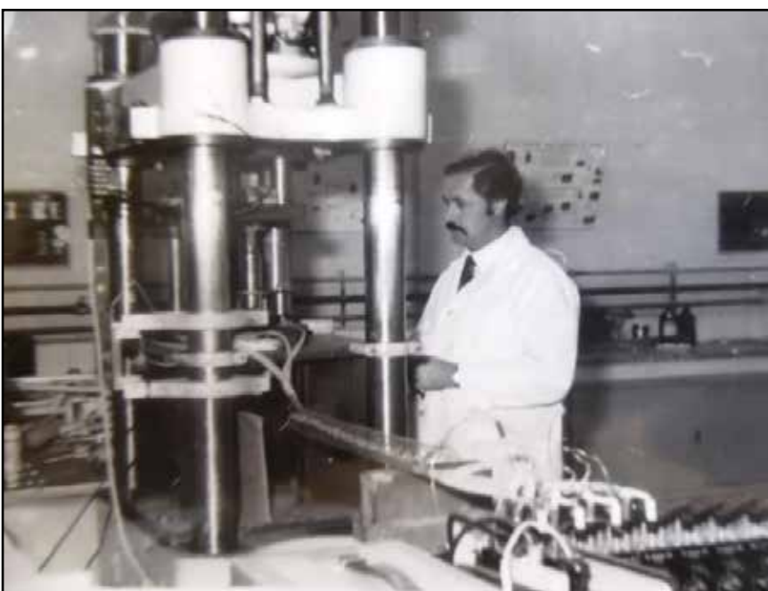
Foto 4: Manejando la prensa hidráulica en un ensayo de embutido de chapas
