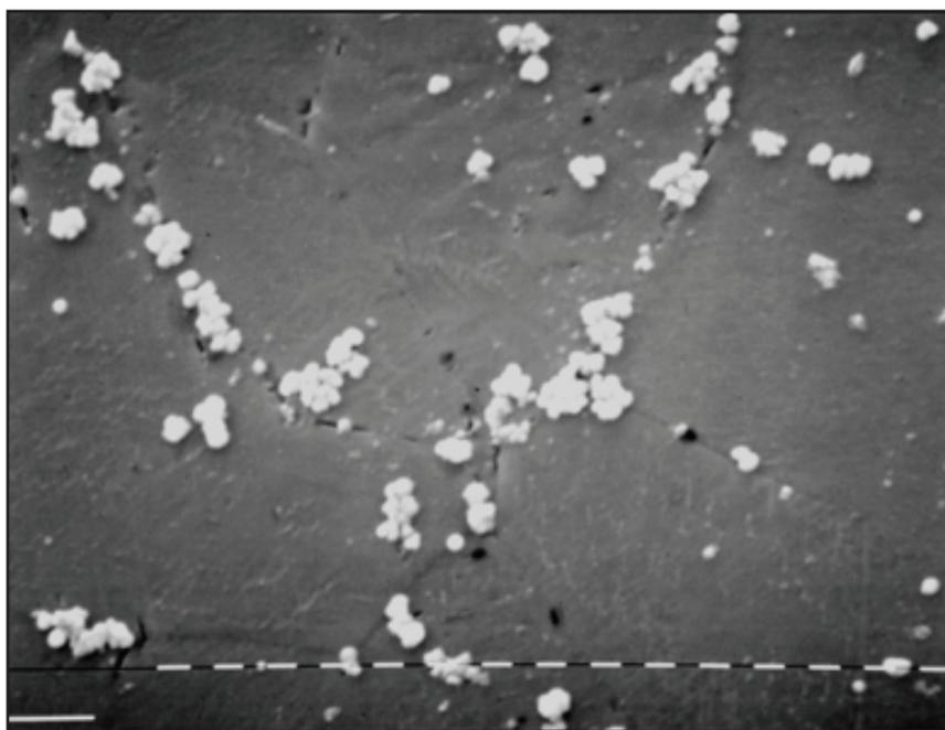
**Figura 1:** Atrapado del hidrógeno en bordes de grano (pequeños puntos blancos). Acero inoxidable austenítico. Técnica de micro-impresión de hidrógeno.
