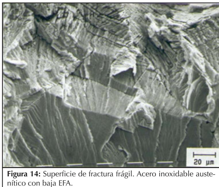
**Figura 14:** Superficie de fractura frágil. Acero inoxidable austenítico con baja EFA.
