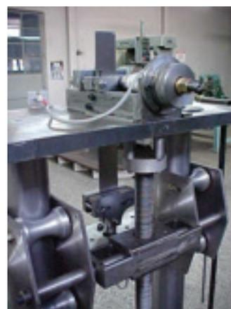
**Figura 18:** Detalle del equipo de fricción de chapas.
