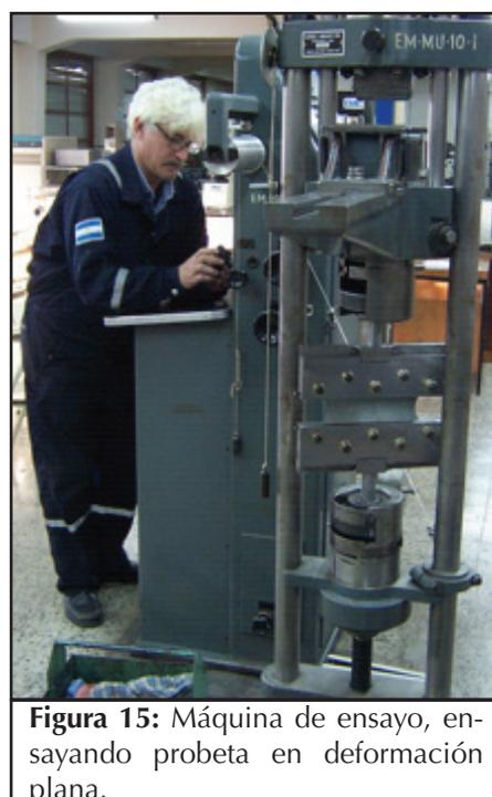
**Figura 15:** Máquina de ensayo, ensayando probeta en deformación plana.
