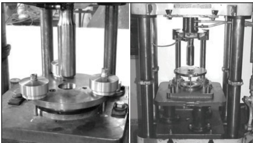
**Figura 11:** Estampa para el ensayo Swift. Laboratorio de Metalurgia y Tecnología Mecánica de la Universidad Nacional del Sur.
