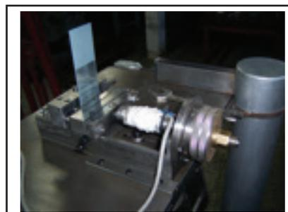
**Figura 17:** Detalle del equipo de fricción de chapas con probeta.
