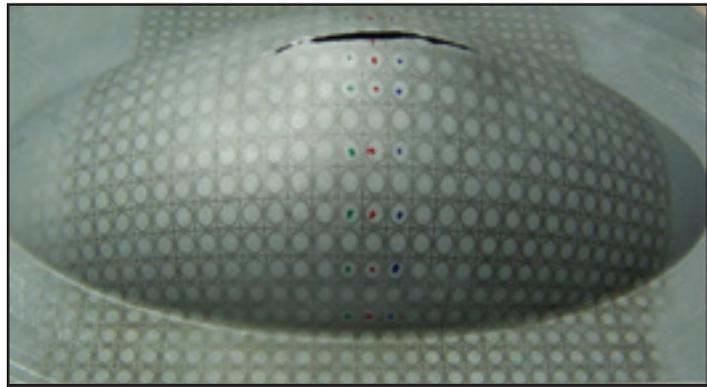
**Figura 14:** Probeta grillada de acopado biaxial elíptico.
