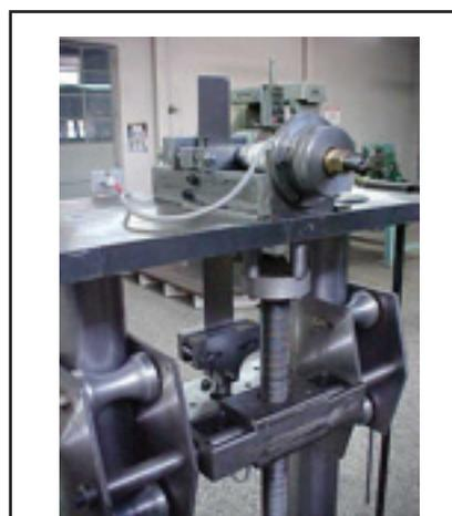
**Figura 18:** Detalle del equipo de fricción de chapas.
