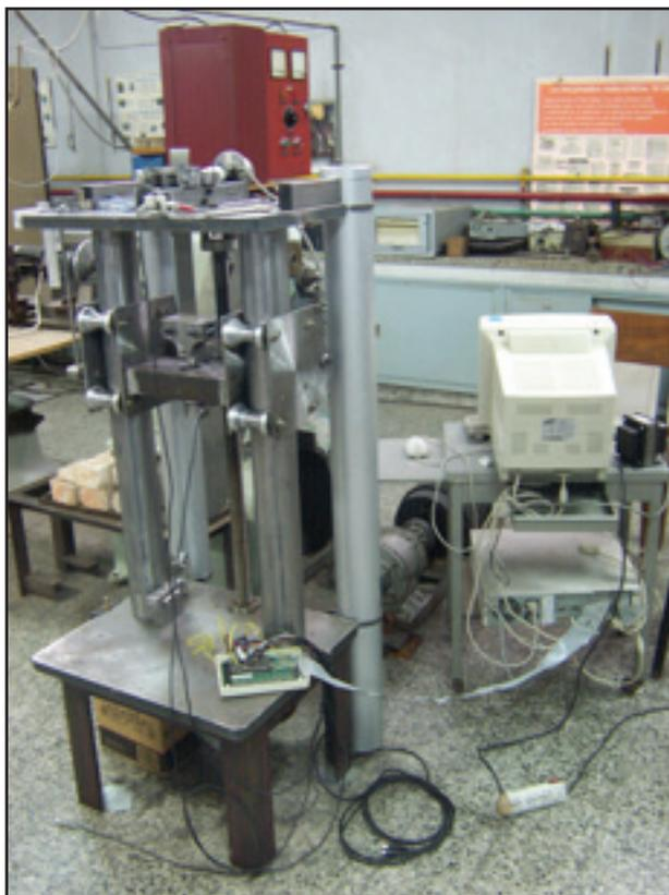
**Figura 16:** Equipo de fricción de chapas.
