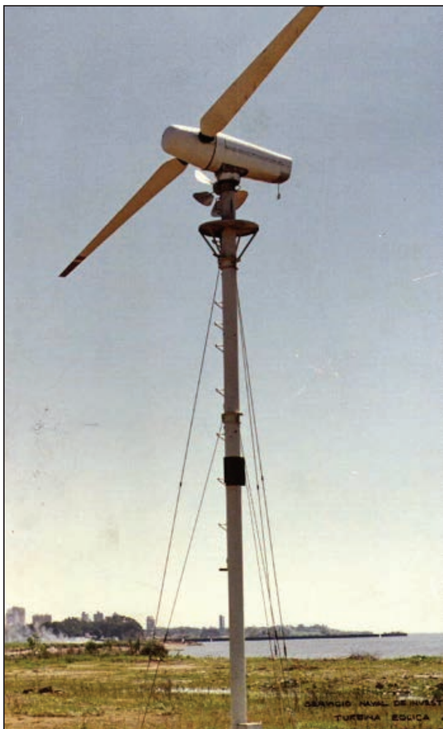
Figura 12: Turbina Eólica Argentina (T.E.A) de 10 KW.
