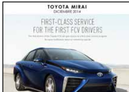
Figura 39: Primer vehículo Japonés, Toyota Mirai (futuro) con pila de combustible e hidrógeno. Rango 600 km, tiempo de carga: 3 minutos.
