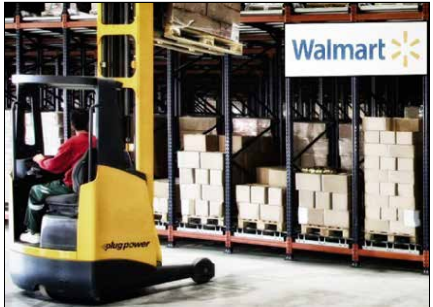
Figura 49: Auto-elevadores a hidrógeno con pila de combustible, movimiento de alimentos en supermercados.
