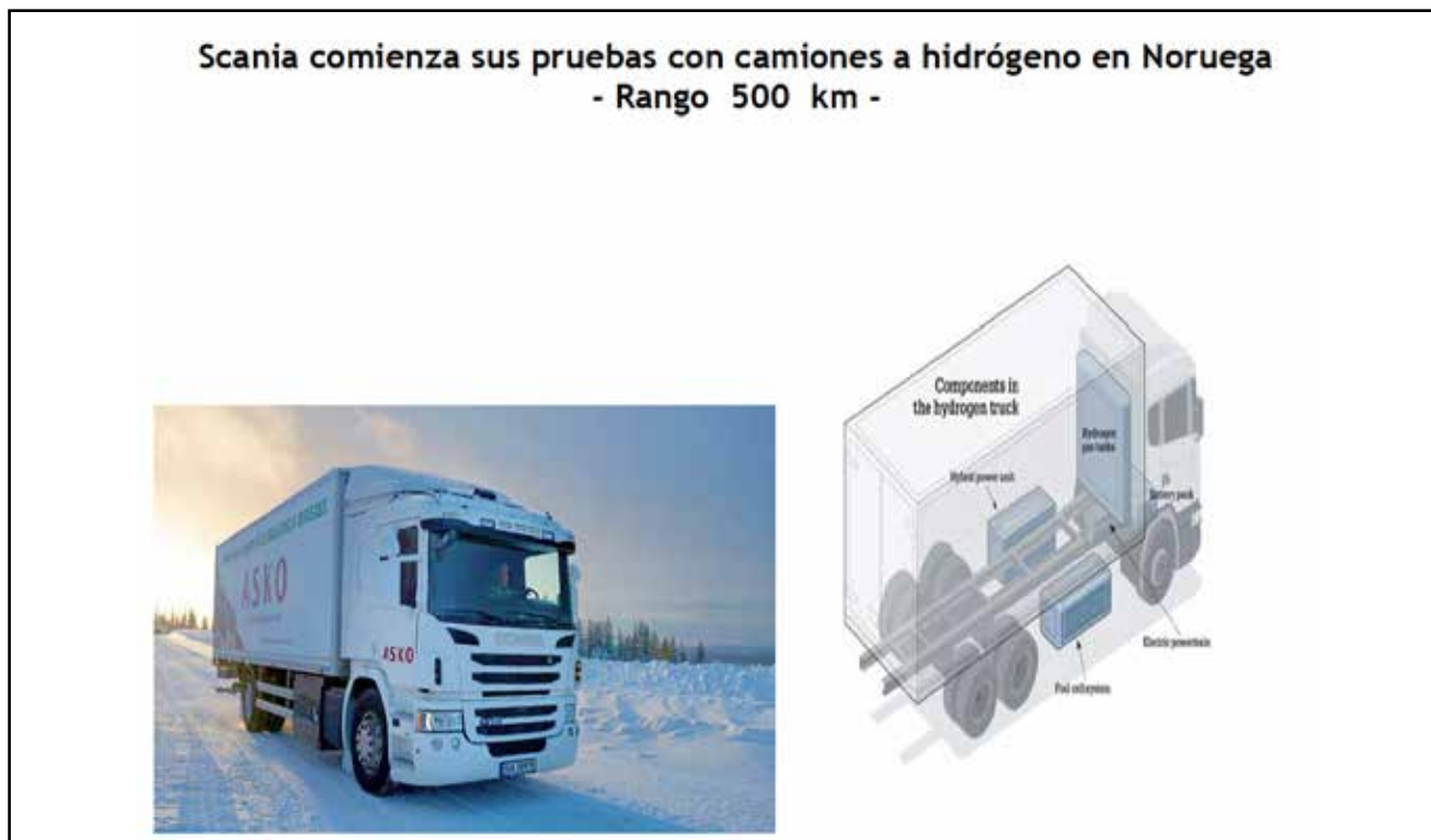
Figura 42: Camión Scania a hidrógeno, pila de combustible.
