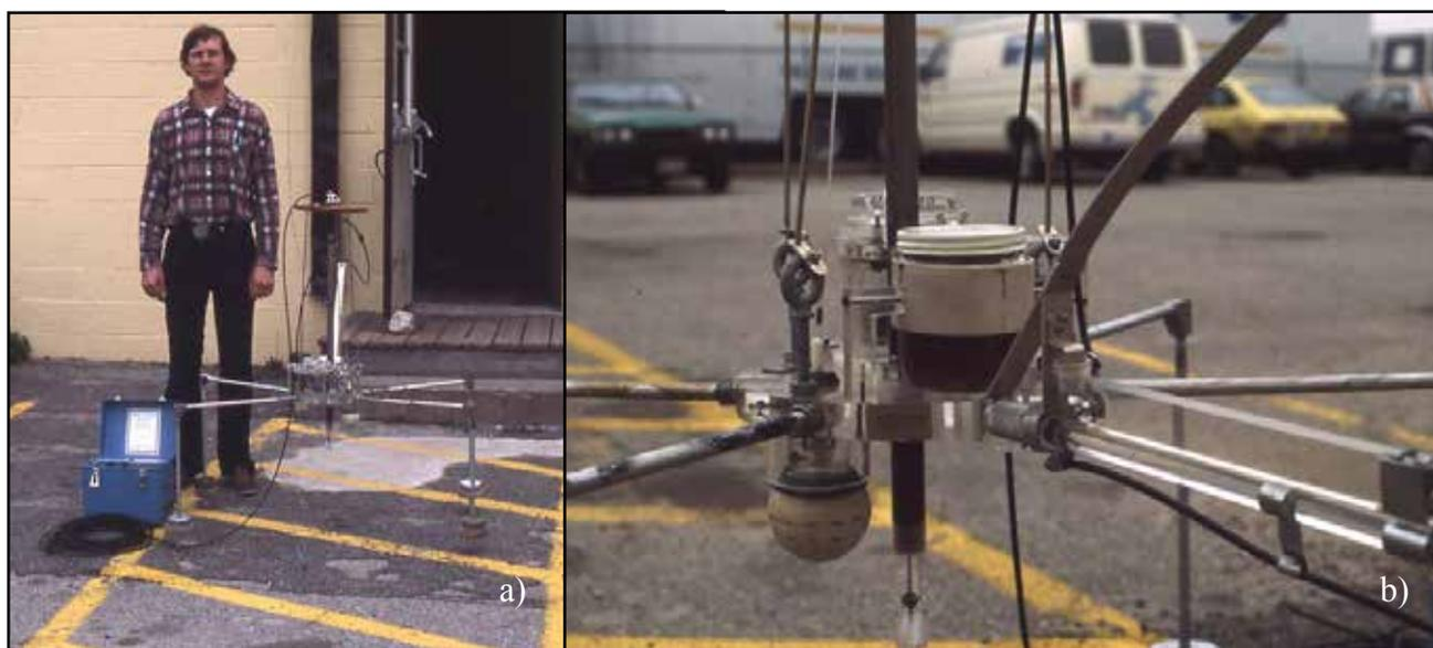
**Figura 1:** Tetrápodo construido por el autor para su tesis de doctorado a) vista general, al lado el técnico John Keating que participó activamente durante las campañas de muestreo; b) vista del sistema de relojería y sensores de dirección y actitud de la estructura.
