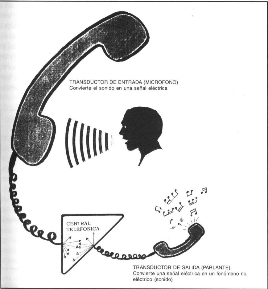
Figura 2. Transductores de entrada y de salida. El micrófono y el parlante de un teléfono son verdaderos transductores.
