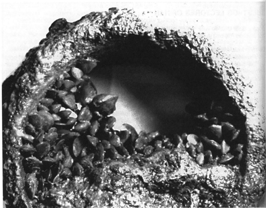
Fig. 1.- "Colonia" de Limnoperna fortunei creciendo dentro de un caño de cemento.
