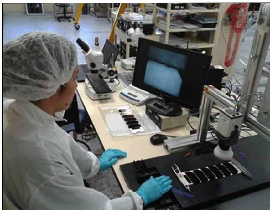
Figura 16. Detección de microfisuras en celdas mediante electroluminiscencia. La subcadena bajo inspección consiste de seis celdas soldadas en serie.
