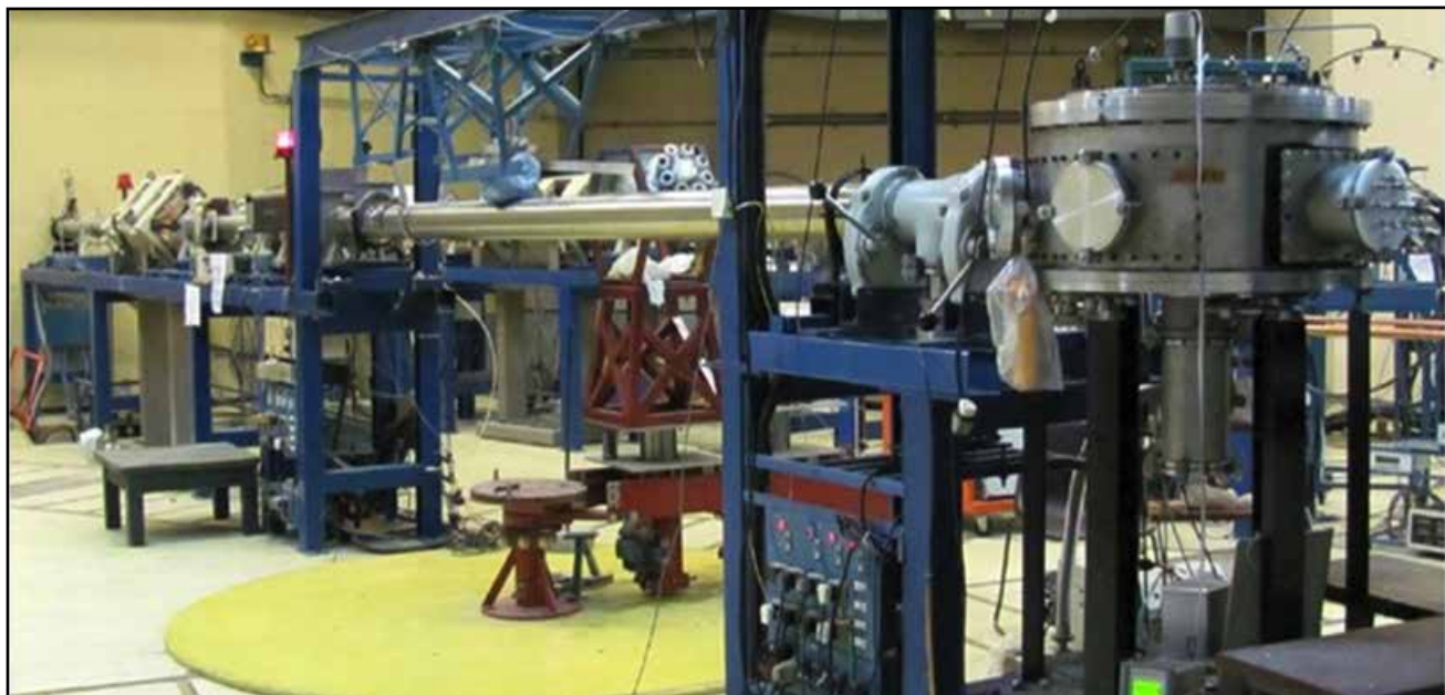
Figura 19. Cámara de termovacío para ensayos de daño por radiación y línea de haz de protones de 10 MeV en el acelerador de iones "Tandar" del CAC-CNEA.
