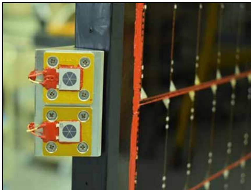
Figura 22. Sensor solar de silicio fabricado en el DES-CNEA utilizado en las misiones SAOCOM 1A y 1B y en Aquarius/SAC-D.
