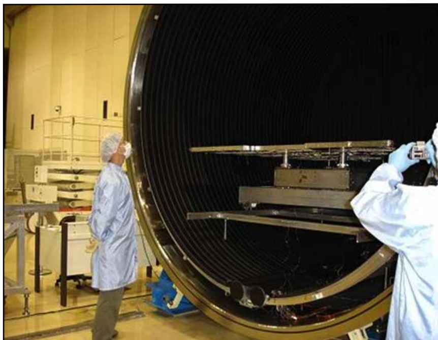
Figura 18. Panel de ingeniería del SAC-D ingresando a la cámara de termovacío en el Instituto Nacional de Pesquisas Espaciales (INPE-Brasil) en 2010. Los ensayos realizados incluyeron ciclos de +85^{\circ}\text{C} a -100^{\circ}\text{C} de amplitud térmica.
