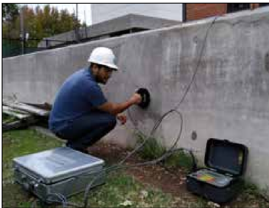
Figura 11. Equipo comercial que permite la medición de la velocidad de corrosión de las armaduras.
