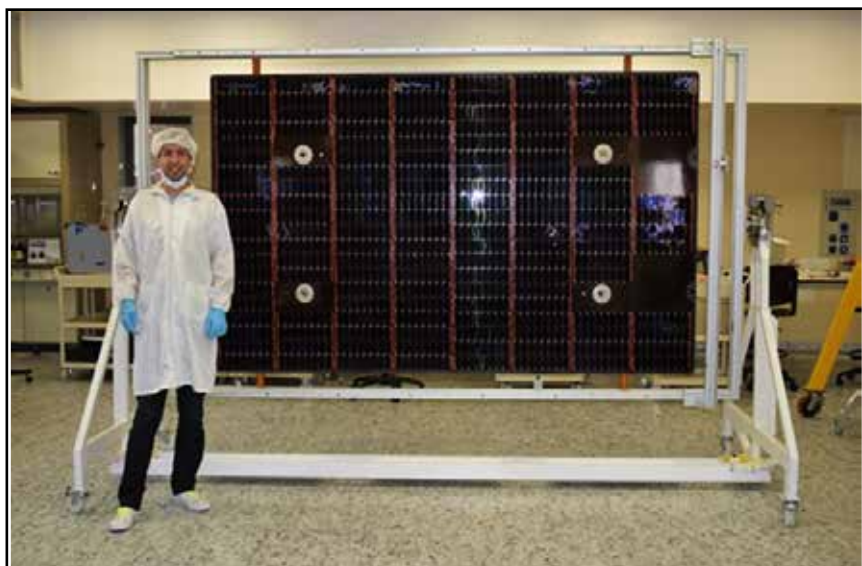
Figura 17. Uno de los tres paneles solares del SAOCOM 1B en el laboratorio de integración (CAC-CNEA). La potencia total del sistema de potencia es de 3584 W.
