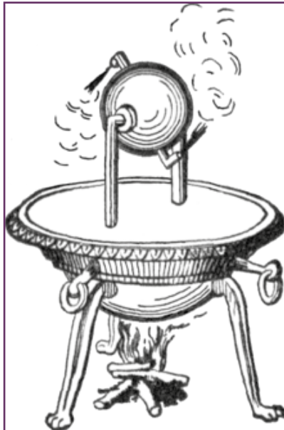
Figura 224. Eolípila según Herón de Alejandría. Fuente: Wikipedia https://en.wikipedia.org/wiki/Aeolipile
