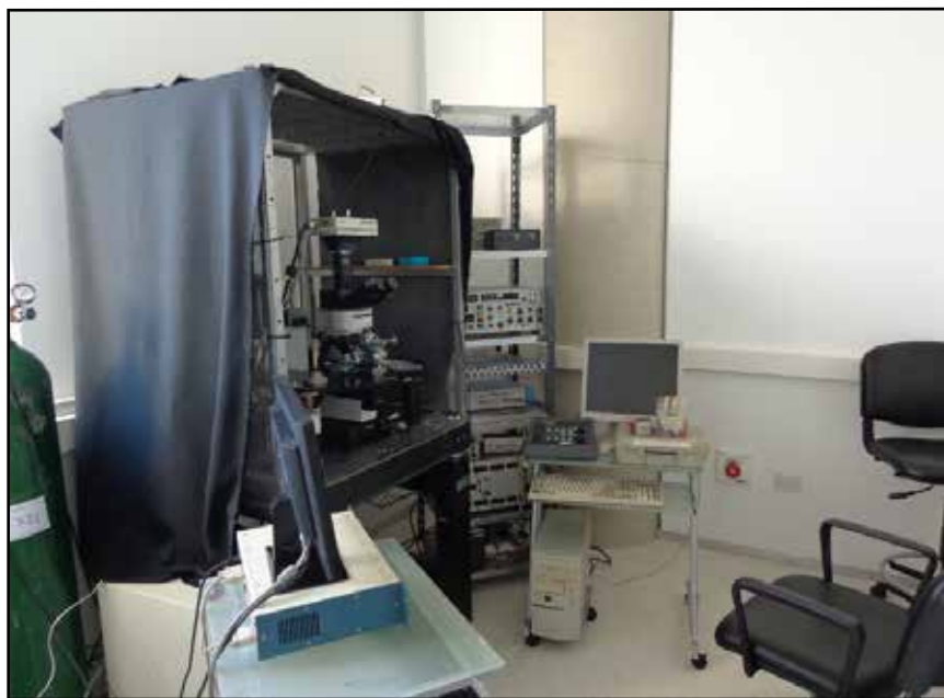
Figura 5: Set Up o conjunto de equipos electrónicos organizados alrededor de un microscopio que tiene montada una cámara de video de alta sensibilidad. El microscopio posa sobre una mesa antivibratoria y está a su vez instalada en una jaula de Faraday (cubierta con una tela oscura) para evitar las interferencias eléctricas del exterior
