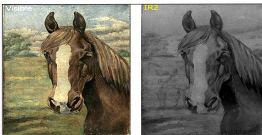
**Figura 18:** Imagen visible de un cuadro (izq.) y reflectografía infrarroja (der.)<sup>7,12</sup>
