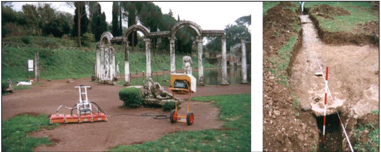
**Figura 15:** Zona inspeccionada por geo-radar (izq.) y descubrimiento del canal encontrado (der.)<sup>10</sup>
