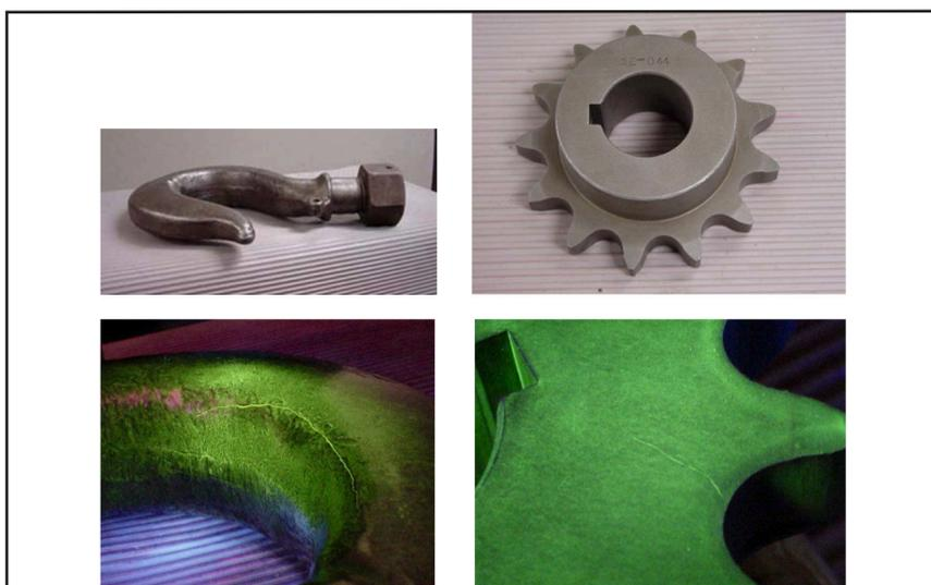
**Figura 8:** Dos componentes, con sus respectivas imágenes de PM abajo, en ambos se detectaron fisuras<sup>1</sup>
