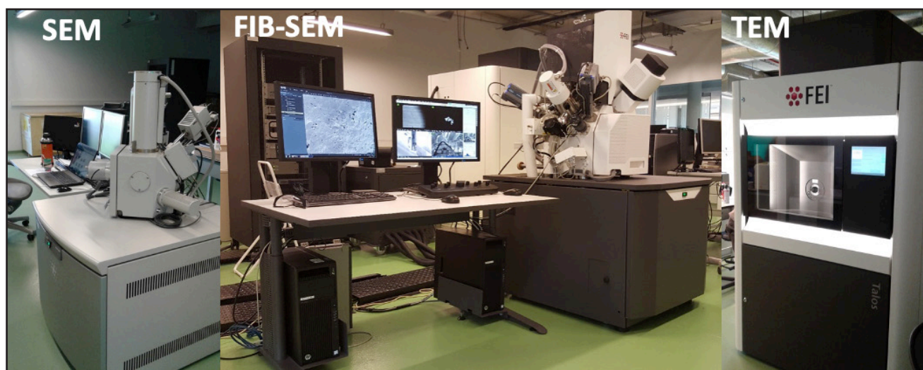
Figura 4: Las tres escalas de la microscopía electrónica en Y-TEC; Micro (SEM), Nano (FESEM, FIB-SEM) y Atómica (TEM).
