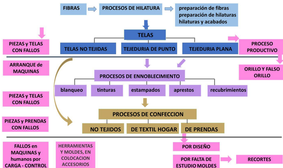
Figura 1. Diagrama el esquema de organización tradicional de la industria textil. Autoría propia.
