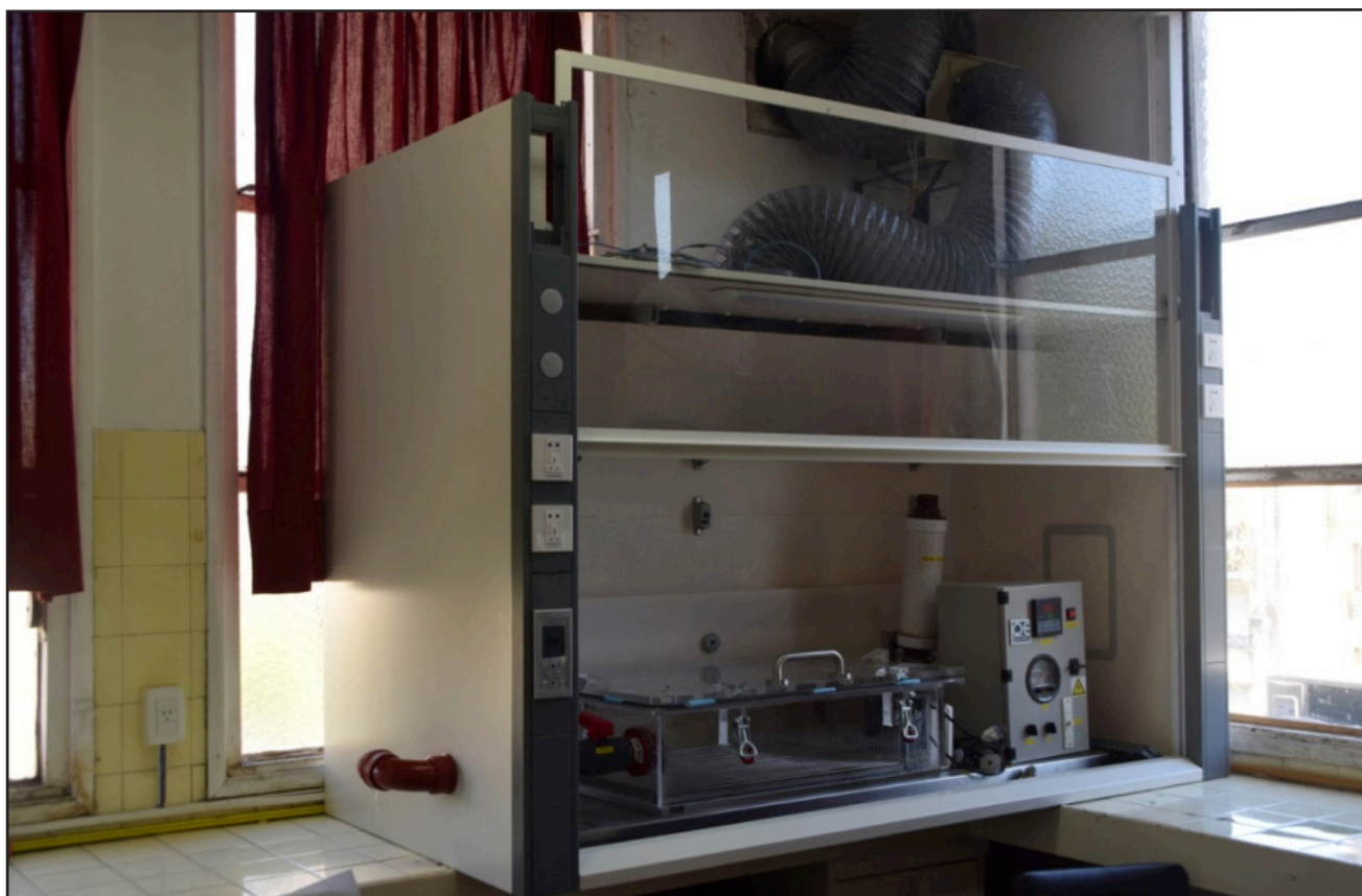
Cámara herméticamente cerrada con panel con movimiento de cierre arriba-abajo. Sobre la derecha controles para llevar la combustión de hasta 180 °. En la parte media jaula hermética para contener hasta 8 roedores, con salida al exterior (ver parte superior de la caja) y toma de aire externo.
