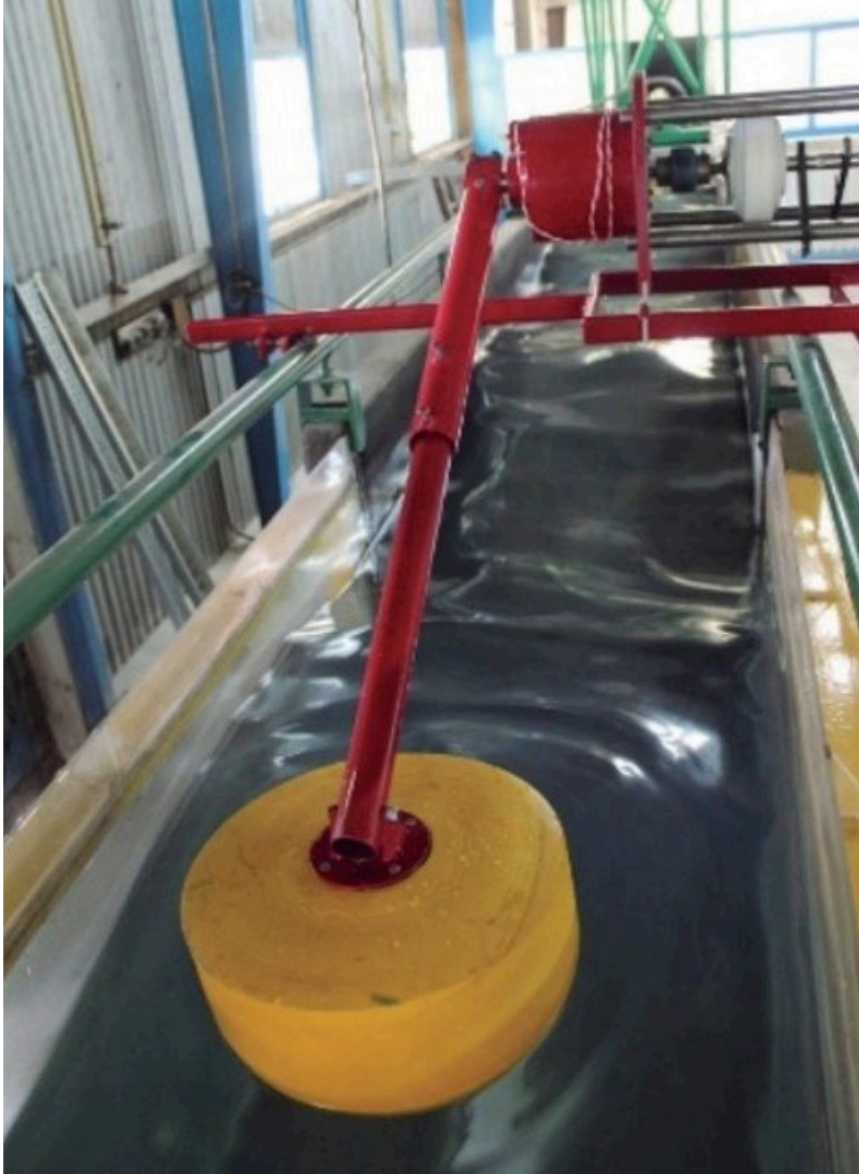
Figura 13. Equipo a escala 1:10 en el canal de olas del INA. Fuente: Pelissero et al. (2020).
