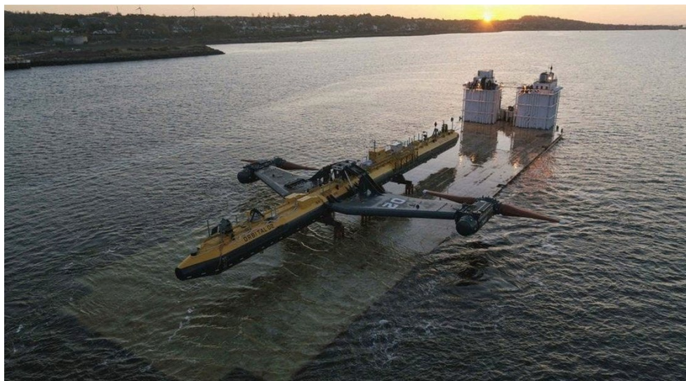
Figura 1. Convertidor de corrientes de marea O2 de 2 MW construido por Orbital Marine Power cuando está siendo remolcado hacia el sitio de pruebas EMEC en Orkney. Escocia. Fuente: https://orbitalmarine.com/
