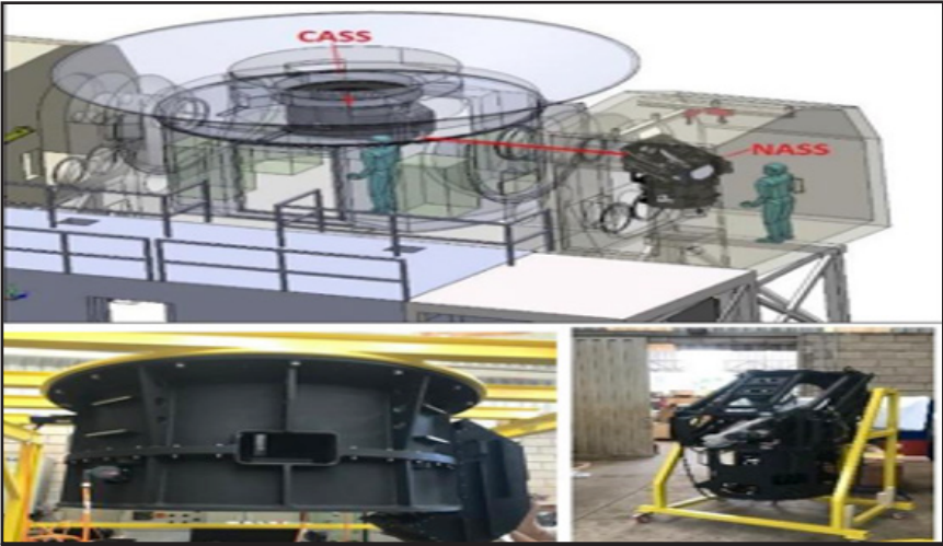
Figura 6. Arriba: Descripción general de dónde estarán ubicadas las partes del sistema mecánico NACOS. Abajo: Las componentes CASS y NASS, desarrolladas en las instalaciones de ALFA Engenharia (Araraquara, Brasil).
