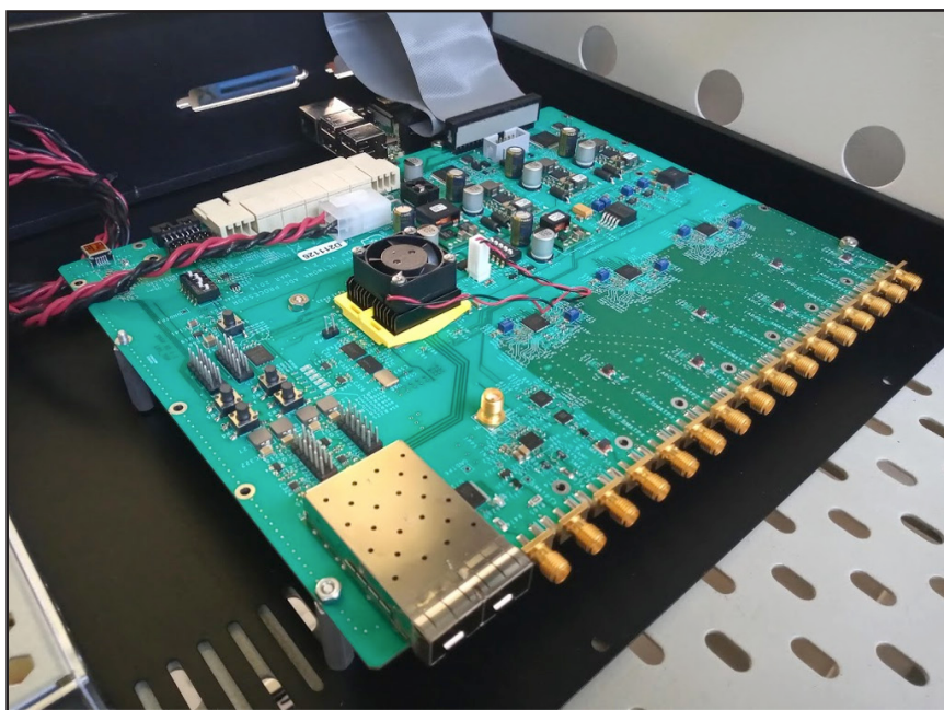
Figura 10. Receptor digital y correlador del prototipo de tres antenas instalado en el IAR. El sistema se basa en una placa programable SNAP CASPER.
