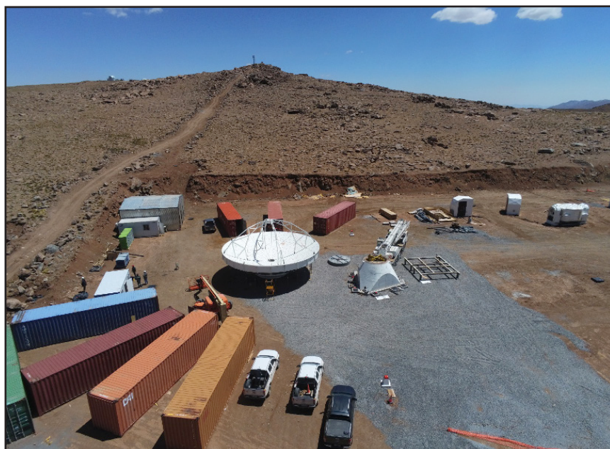
Figura 14. Vista aérea de la antena con su quadrapod. A la derecha se localiza el pedestal. A lo lejos puede verse la antena de holografía y la cúpula del telescopio de QUBIC.
