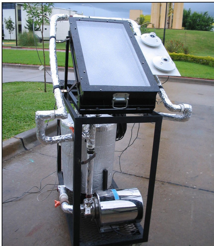
Figura 4: Fotografía del reactor solar “híbrido” de planta piloto patentado.
