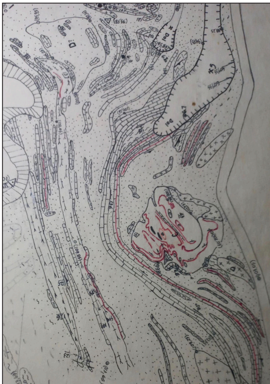
Figura 6. Plegamiento superpuesto, figura de interferencia de tipo 1 en transición a tipo 2, con morfología de domos y cuencas (D y C), cartografiada con plancheta autoreductora Kern mediante curvas de forma y aislamiento de afloramientos (ancho de la figura C \approx 50 metros). Recorte del Mapa 7, Escala 1:1.000, de mi tesis doctoral (Martino 1988).
