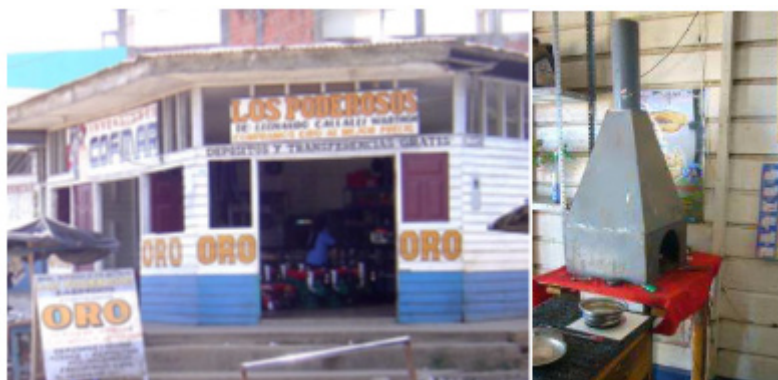
Figura 36. Tienda de oro y un horno de quemado de amalgama en Laberinto, Perú. Fuente: Fernández L.E. (2008). EPA Proyecto Reducción de emisiones de mercurio en la extracción y refina de oro artesanal. Ver: http://www.minem.gob.pe/minem/archivos/file/DGAAM/mercurio/Gold%20Shop%20Presentation%20-%20Lima%20MEM%20-%20Sep%202015.pdf
